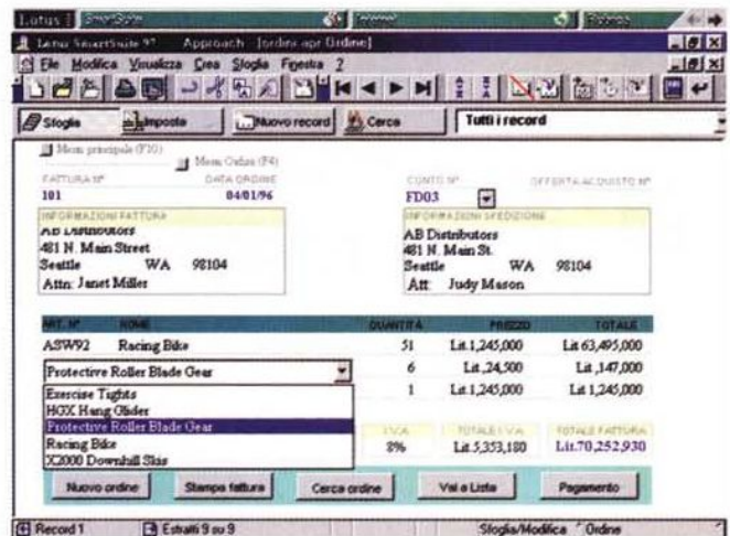
Figura 10 - Lotus SmartSuite 97 - Approach - Un Modulo complesso preso da uno SmartMaster. Approach è un prodotto di tipo DBMS medio. Rappresenta un buon compromesso tra semplicità d'uso e potenza in termini di complessità delle applicazioni realizzabili. Qui vediamo un classico Modulo di acquisizione Ordini, che "sotto" richiede un Database basato su almeno quattro tabelle. L'applicazione Ordini, da cui è preso questo modulo, è costruita completamente partendo da uno SmartMaster.
